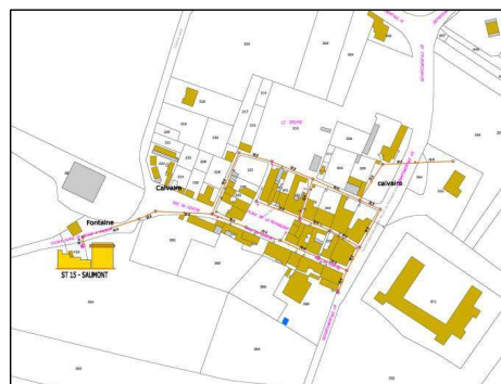
Réseau d'assainissement unitaire
